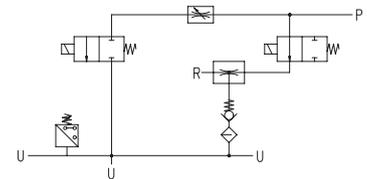
P=CONNESSIONE ARIA COMPRESSA    R=SCARICO    U=CONNESSIONE VUOTO
