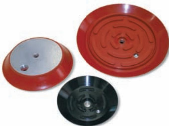
Questa serie di ventose è stata progettata per il sollevamento e la movimentazione di grossi carichi, sia in orizzontale che verticale. Vulcanizzate su un supporto d'acciaio, hanno un foro filettato centrale per il fissaggio all'automatismo e uno laterale per la connessione del vuoto.
