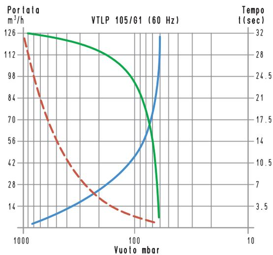
Per calcolare il tempo di svuotamento di un volume  $V_1$ , applicare la formula seguente:  $t_1 = \frac{t \times V_1}{100}$
