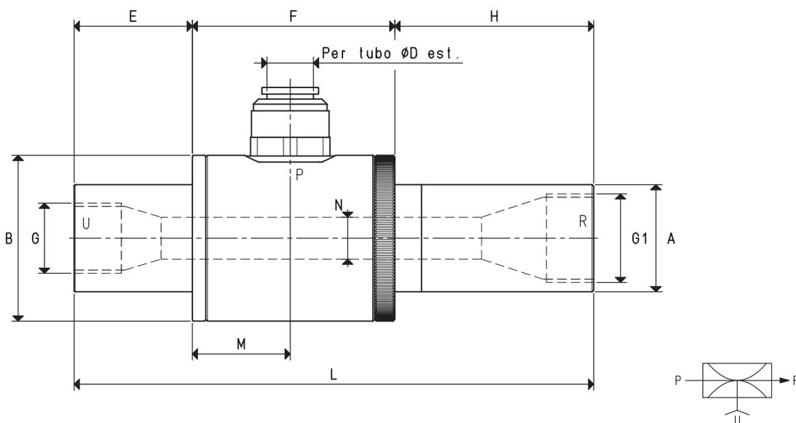
P=CONNESSIONE ARIA COMPRESSA    R=SCARICO    U=CONNESSIONE VUOTO
